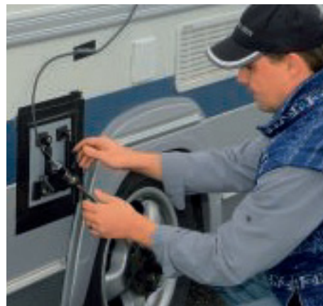
Ein Sensor am Caravanrad liefert exakte Geschwindigkeitswerte während der Messungen.
