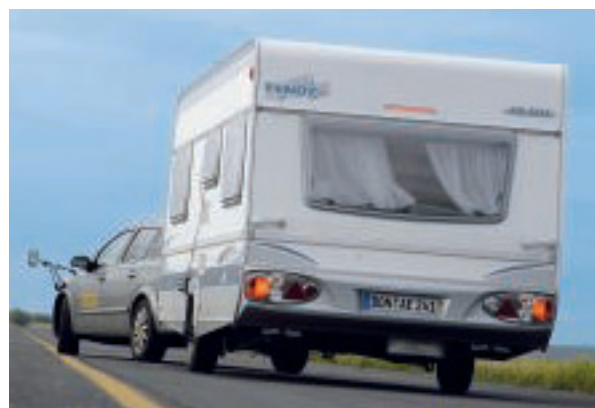
Das Aufleuchten der Bremslichter warnt den nachfolgenden Verkehr beim Eingreifen der ESP-Regelung.
